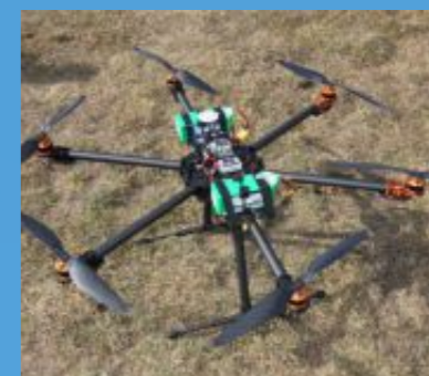
Zde vidíme při zalétání větší dron (bez kamery), řady 960 (rozpětí ramen bez vrtulí, které jsou o průměru 500 mm). Jedná se o dron, který při plné výbavě s kamerou a přenosem obrazu přesahuje hodnotu 150 tisíc Kč. Při použití akumulátorů o síle 10 tisíc mAh se může celková cena vyšplhat až na 400 US za jednu sadu.
