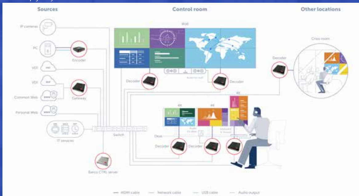
Příklad zapojení systému KVM over IP.
