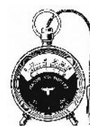
Obr. č. 9: Voltmetr systém Deprez d'Arsonval.
